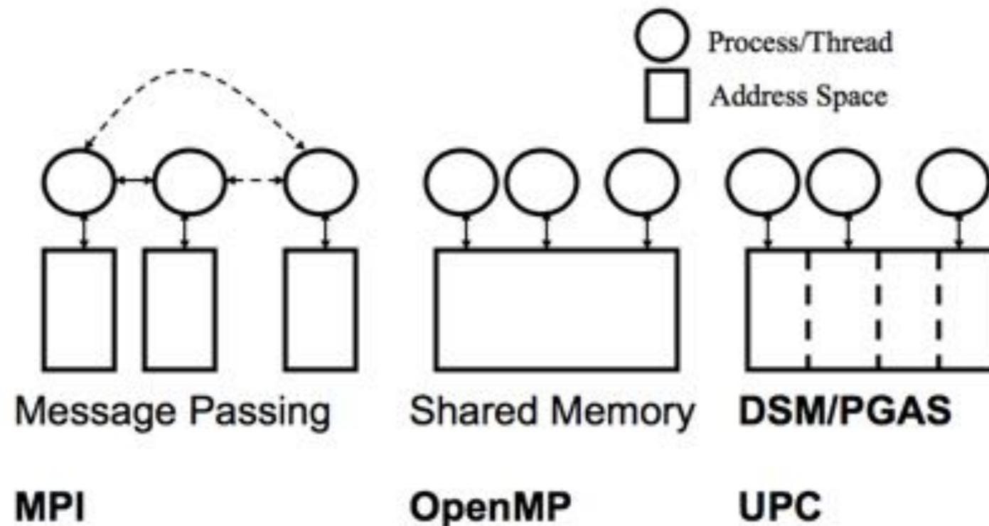
MPIでは明示的にデータの送受信を行う必要があるが、UPCはどのプロセッサからでも共有メモリ空間にアクセスできる
